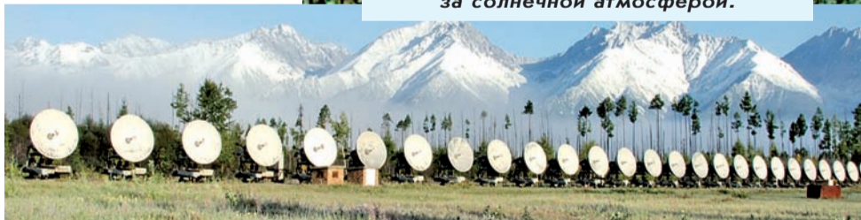
Уникальный солнечный радиотелескоп: две линии антенн по 128 в каждой, установленных под Иркутском, следят за солнечной атмосферой.
