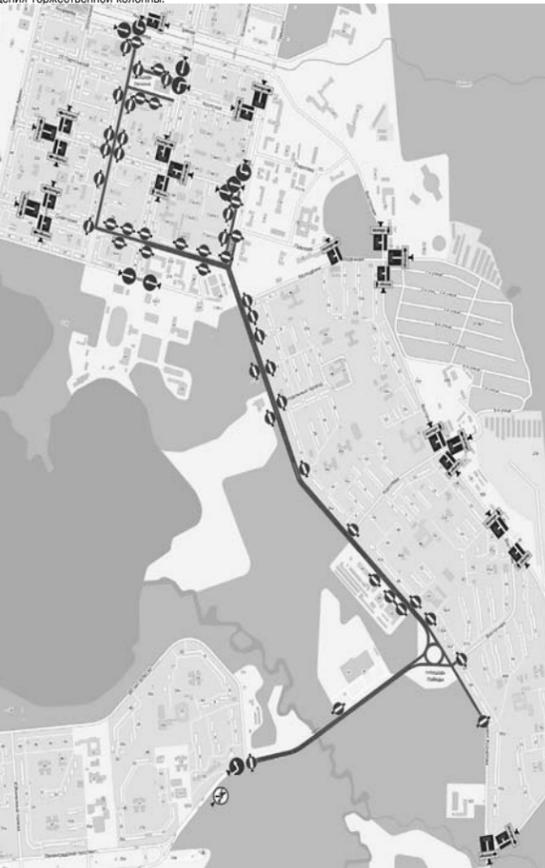
Знаки устанавливаются в соответствии с требованиями ГОСТ Р 52289-2004 «Технические средства организации дорожного движения. Правила применения дорожных знаков, разметки, светофоров, дорожных ограждений и направляющих устройств», ГОСТ Р 52290-2004 «Технические средства организации дорожного движения. Знаки дорожные. Общие технические требования».
