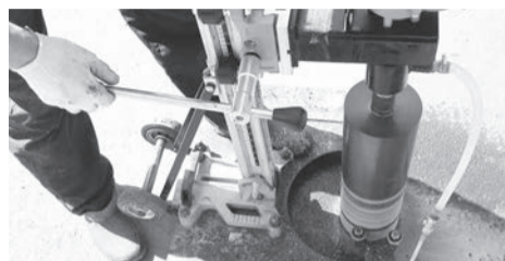
▲▼ Отбор асфальтобетонных кернов выполняют с помощью установки для выбуривания на всю толщину покрытия с дальнейшим разделением слоев в лаборатории.
